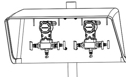
Два датчика дифференциального давления под DIASHADE SD 127 с ВМ-вентильными блоками, установленными на монтажной пластине MP127 (по запросу), на расположенной снаружи трубной стойке. Подключение импульсных и дренажных трубок с обратной стороны задней стенки (горизонтально).
